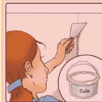
Dès que le revêtement est posé, étaler de la colle au dessus du premier joint sur une largeur correspondant à la bande à joint à installer. Placer la bande à joint dans la colle en chevauchement des lés et maroufler. Coller ensuite de la même façon des bandes à joints au-dessus des autres jonctions de lés.
