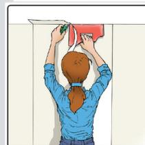
Découper les lés à la longueur voulue (+ 5 cms pour les arasements). Ensuite, encoller suffisamment et régulièrement le support (mur ou plafond) au rouleau à poils 12 mm, sur une largeur de un lè (+/-300 gr/M2).
